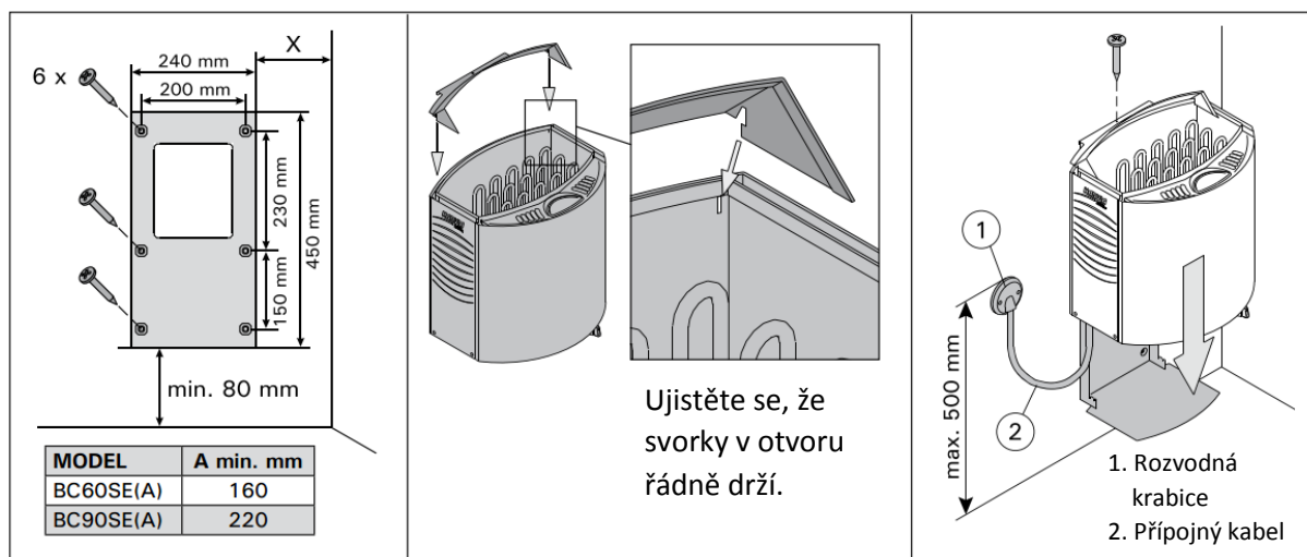
Obrázek 6. Připevnění topidla na zeď
