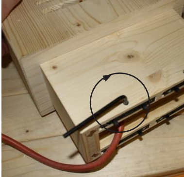
Obr. 30: Ukotvenie predného žiariča
